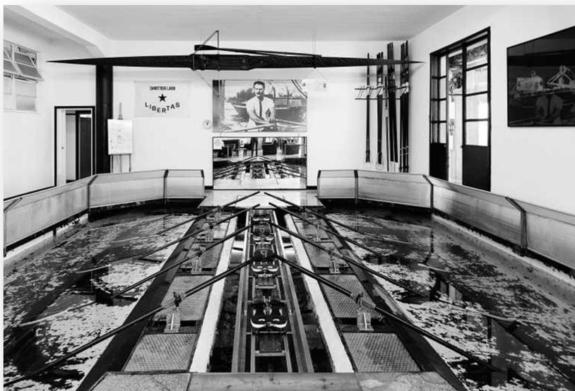
La vasca voga per l'addestramento con imbarcazione fissa è la prima del genere in Italia. Artigianato e ingegneria idraulica sono al servizio dell'esercizio sportivo: un sistema di canali simula la corrente contraria al senso del vogatore che rema sopra una barca galleggiante ancorata.
